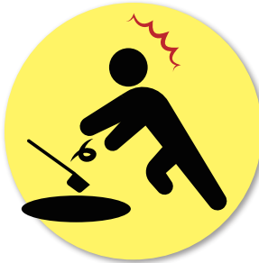
落下した物が中の 作業員に当たる危険
