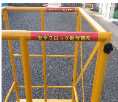
4 クロス柵をボルトで4カ所を固定
