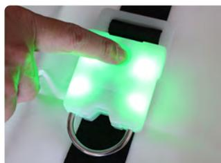
電源を切るときは、再度電源スイッチを長押し
