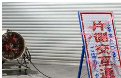
！ウエイト設置がされていない看板は風速約6m/sで転倒します。
